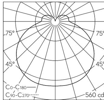
LED 3000 K 26.2 W 2288 lm-h / CIE Flux 38 68 88 80 100 / B31 selon DIN 5040
