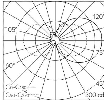
LED 3000 K 14.6 W 1465 lm-h / CIE Flux 14 38 67 49 100 / C11 selon DIN 5040
