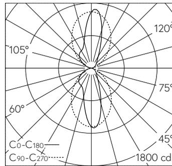
LED 4000 K 28.1 W 2678 lm-h / CIE Flux 61 87 98 50 100 / C54 selon DIN 5040
