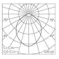
LED 3000 K 9.7 W 986 lm-h / CIE Flux 55 87 97 92 100 / A52 selon DIN 5040
