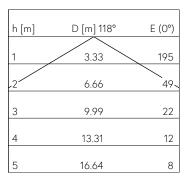
LED 4000 K 11 W 602 lm-h 118° / CIE Flux 45 76 94 100 100 / A40 selon DIN 5040
