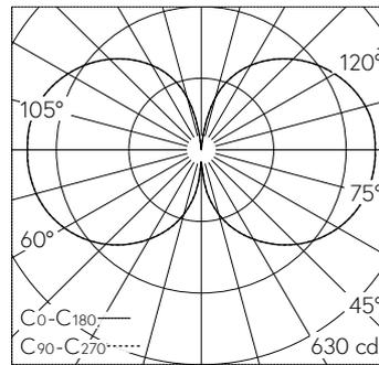
LED 4000 K 50.5 W 5217 lm-h / CIE Flux 17 42 69 51 100 / C11 selon DIN 5040
