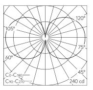
LED 3000 K 19.3 W 2026 lm-h / CIE Flux 17 41 69 51 100 / C11 selon DIN 5040
