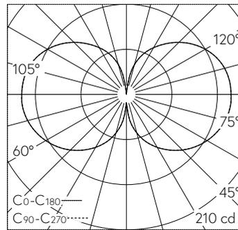
LED 3000 K 18 W 1636 lm-h / CIE Flux 17 41 69 51 100 / C11 selon DIN 5040
