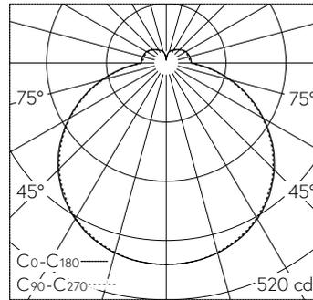
LED 2700 K 17,6 W 1839 lm-h / CIE Flux 41 70 90 84 100 / B31 selon DIN 5040
