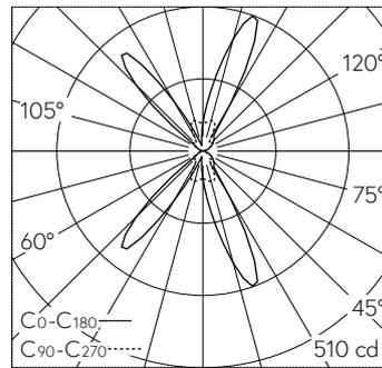
LED 3000 K 14 W 307 lm-h / CIE Flux 68 94 99 50 100 / C64 selon DIN 5040
