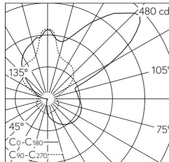
LED 3000 K 14 W 1158 lm-h / CIE Flux 25 51 76 29 100 / D13 selon DIN 5040
