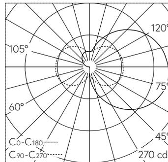
LED 3000 K 14.8 W 1094 lm-h / CIE Flux 16 41 69 49 100 / C12 selon DIN 5040
