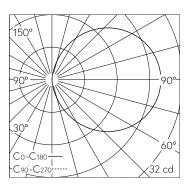
LED 2700 K 3 W 76 lm-h / CIE Flux 13 37 66 50 100 / C11 selon DIN 5040
