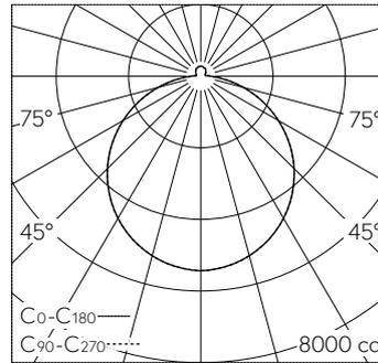
LED 3000 K 134 W 17294 lm-h / CIE Flux 45 76 93 94 100 / A42 selon DIN 5040
