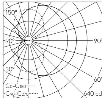
LED 3000 K 22.5 W 2286 lm-h / CIE Flux 32 59 80 50 100 / C22 selon DIN 5040
