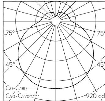
LED 2700 K 47.4 W 3858 lm-h / CIE Flux 38 67 87 77 100 / B32 selon DIN 5040
