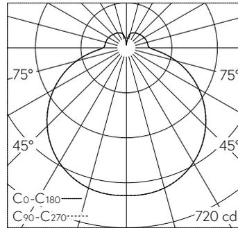
LED 3000 K 31.1 W 2592 lm-h / CIE Flux 40 70 89 81 100 / B32 selon DIN 5040
