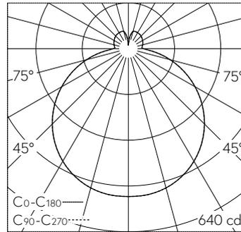
LED 3000 K 19.1 W 2062 lm-h / CIE Flux 42 73 91 83 100 / B32 selon DIN 5040
