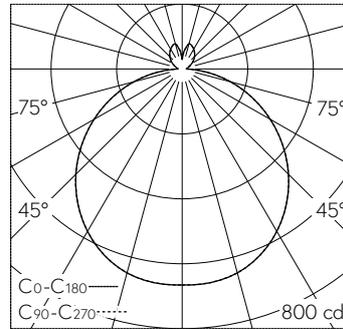
LED 3000 K 28.8 W 2488 lm-h / CIE Flux 46 76 94 89 100 / B43 selon DIN 5040
