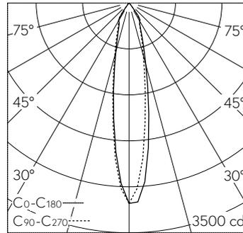
LED 3000 K 10.3 W 743 lm-h / CIE Flux 98 100 100 100 100 / A80 selon DIN 5040
