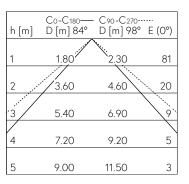
LED 3000 K 2.7 W 204 lm-h 84°/98° / CIE Flux 66 94 99 100 100 / A60 selon DIN 5...
