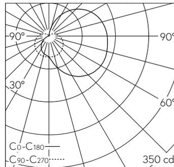
LED 4000 K 5.8 W 549 lm-h / CIE Flux 25 51 76 63 100 / B11 selon DIN 5040
