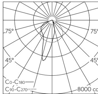
LED 3000 K 35.6 W 5042 lm-h / CIE Flux 59 88 100 100 100 / A50 selon DIN 5040
