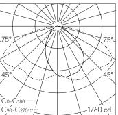
LED 3000 K 30.4 W 3411 lm-h / CIE Flux 42 76 95 100 100 / A30 selon DIN 5040
