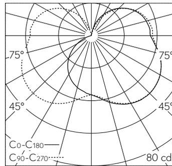
LED 3000 K 4.7 W 378 lm-h / CIE Flux 27 55 78 63 100 / B21 selon DIN 5040
