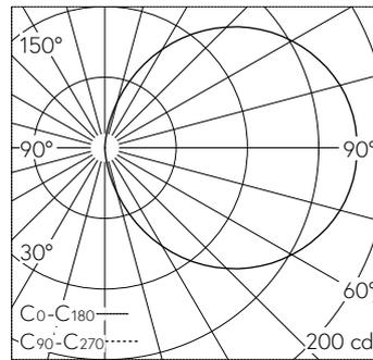
LED 3000 K 6.7 W 638 lm-h / CIE Flux 13 37 66 50 100 / C11 selon DIN 5040
