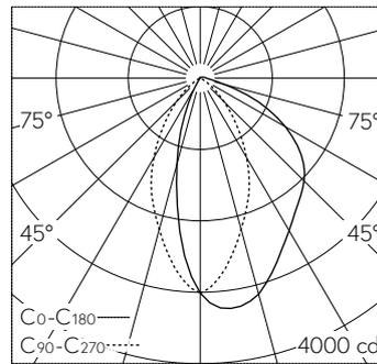
LED 3000 K 34 W 3687 lm-h / CIE Flux 62 87 98 99 100 / A50 selon DIN 5040
