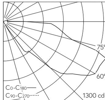
LED 4000 K 14 W 1340 lm-h / CIE Flux 4 34 75 97 100 / A10 selon DIN 5040
