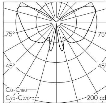
LED 3000 K 14.3 W 802 lm-h / CIE Flux 19 44 70 58 100 / C11 selon DIN 5040
