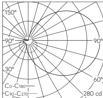
LED 3000 K 9 W 815 lm-h / CIE Flux 19 44 70 58 100 / C11 selon DIN 5040
