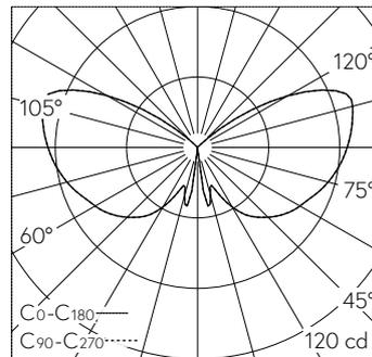
LED 3000 K 14.3 W 695 lm-h / CIE Flux 15 39 67 56 100 / C11 selon DIN 5040
