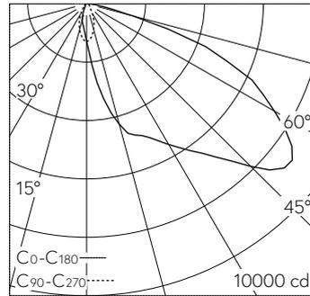
LED 4000 K 58.5 W 7160 lm-h / CIE Flux 37 74 98 100 100 / A30 selon DIN 5040
