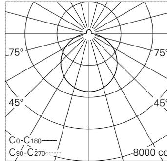
LED 3000 K 101 W 12365 lm-h / CIE Flux 44 75 92 90 100 / A42 selon DIN 5040
