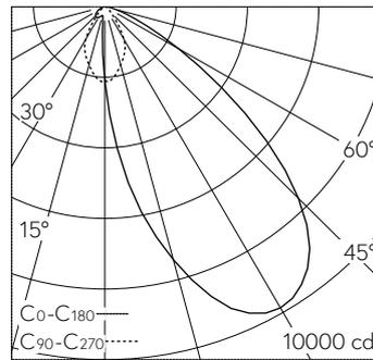
LED 3000 K 60 W 6591 lm-h / CIE Flux 66 95 99 100 100 / A60 selon DIN 5040
