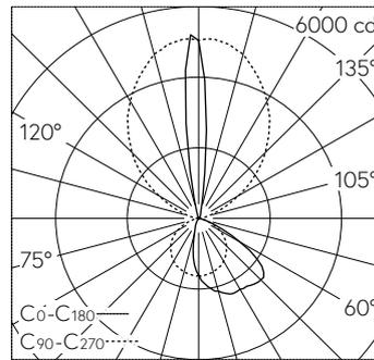
LED 3000 K 74 W 7870 lm-h / CIE Flux 47 83 97 67 100 / B44 selon DIN 5040
