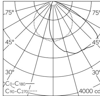
LED 4000 K 39 W 4683 lm-h / CIE Flux 47 83 97 100 100 / A40 selon DIN 5040
