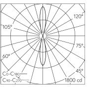
LED 4000 K 9 W 392 lm-h / CIE Flux 99 100 100 50 100 / C84 selon DIN 5040
