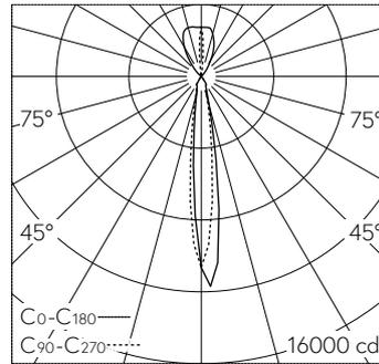
LED 3000 K 35.5 W 2090 lm-h / CIE Flux 99 100 100 72 100 / B84 selon DIN 5040
