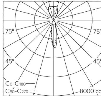
LED 3000 K 18.5 W 1038 lm-h / CIE Flux 98 100 100 72 100 / B84 selon DIN 5040
