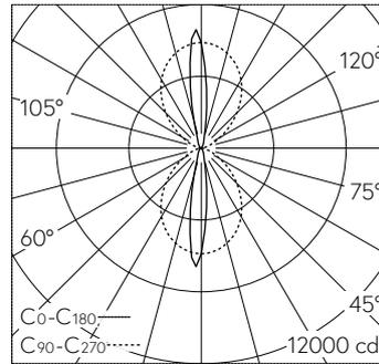
LED 3000 K 74 W 6676 lm-h / CIE Flux 76 94 99 50 100 / C74 selon DIN 5040
