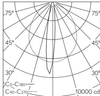
LED 3000 K 39 W 3464 lm-h / CIE Flux 76 93 99 100 100 / A70 selon DIN 5040
