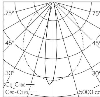
LED 3000 K 26.5 W 2188 lm-h / CIE Flux 77 94 99 100 100 / A70 selon DIN 5040
