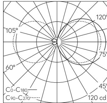
LED 3000 K 11.7 W 766 lm-h / CIE Flux 13 37 66 50 100 / C11 selon DIN 5040
