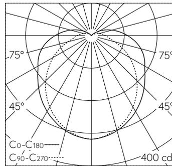
LED 4000 K 14 W 1210 lm-h / CIE Flux 39 67 86 88 100 / B31 selon DIN 5040
