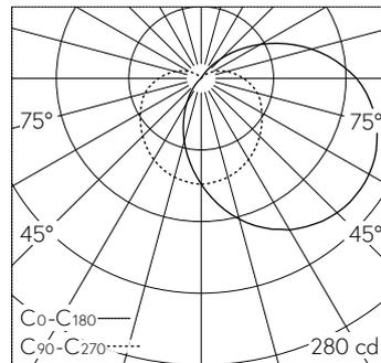
LED 3000 K 10 W 652 lm-h / CIE Flux 30 57 79 77 100 / B21 selon DIN 5040
