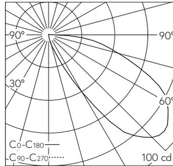
LED 3000 K 6.7 W 116 lm-h / CIE Flux 15 55 86 99 100 / A10 selon DIN 5040
