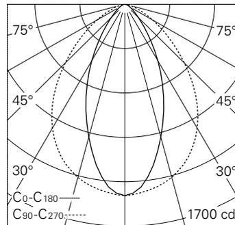
LED 3000 K 15.8 W 1762 lm-h / CIE Flux 77 96 100 100 100 / A70 selon DIN 5040
