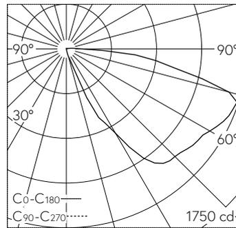
LED 4000 K 13.8 W 1230 lm-h / CIE Flux 16 50 81 99 100 / A10 selon DIN 5040
