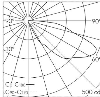
LED 4000 K 4 W 321 lm-h / CIE Flux 12 46 82 99 100 / A10 selon DIN 5040
