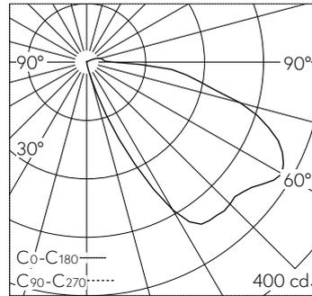
LED 3000 K 4 W 458 lm-h / CIE Flux 18 51 83 96 100 / A11 selon DIN 5040
